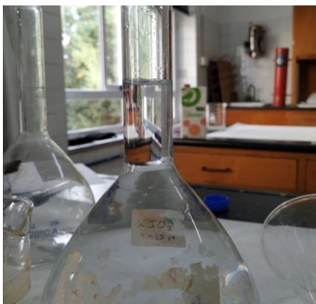
Imagen 2. Ejemplo de un enrase, en un matraz aforado, donde se observa un menisco cóncavo, y su tangente en la marca de aforo. Elaboración propia.
