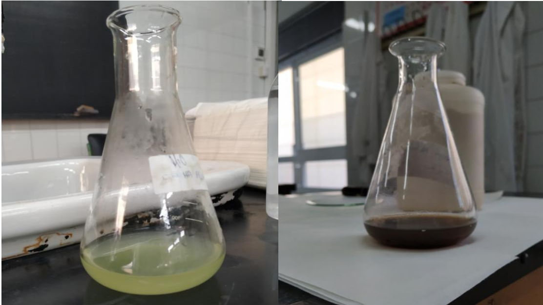
Imagen 2. Cambio de pigmentación gracias al indicador tras la titulación del reactivo con tiosulfato de sodio. Fuente: elaboración propia.
